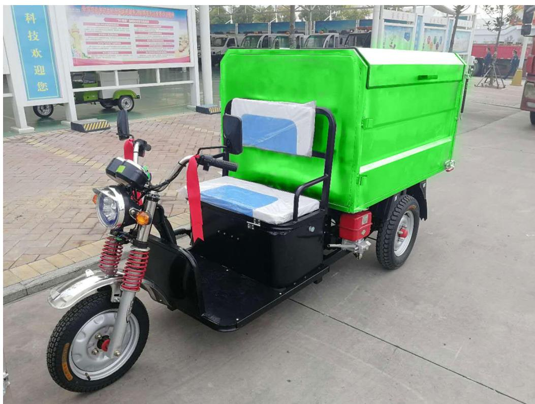
微型电动保洁车（车辆参考图样），装载量约400~600L。
